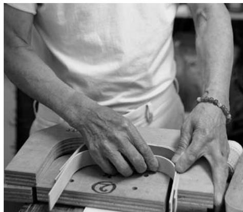
木枠は湯につけて荒曲げし、乾燥させた後、型に嵌めて丸みを出す。
