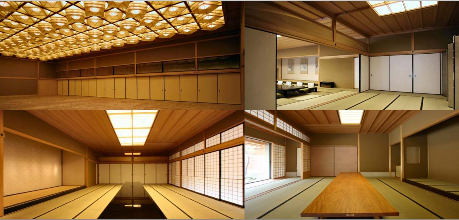
表具の一つ、襖は吸音性・断熱性・調湿に優れ、部屋の間仕切りとして、優れた機能を備え持つ。種類の異なる和紙を何枚も重ね合わせて作る襖の工程は、表面では分かりえない工夫が施される。落ち着いた柔らかい雰囲気醸し出す襖の奥深さを再認識したい。
