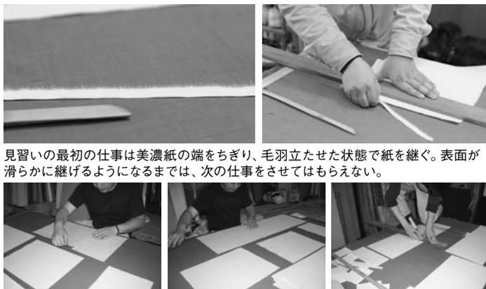
見習いの最初の仕事は美濃紙の端をちぎり、毛羽立たせた状態で紙を継ぐ。表面が滑らかに継げるようになるまでは、次の仕事をさせてはもらえない。
