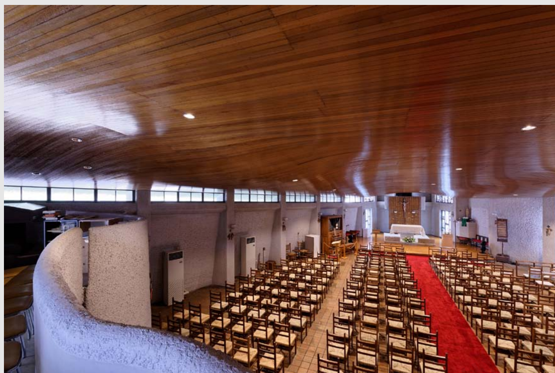
内観 中2階より整然と並ぶ椅子群を介して祭壇を望む 左側内壁は高窓を配し、防音・音響に配慮している
