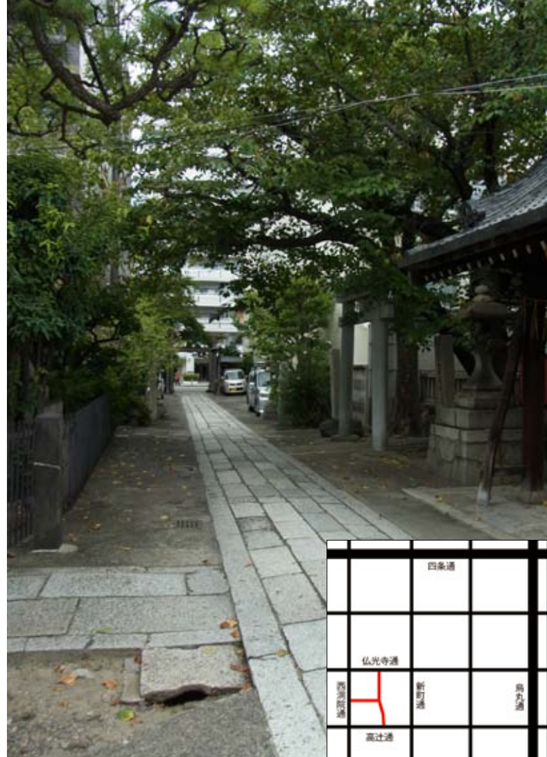
③菅大臣社路地(仏光寺通～西洞院通～高辻通) 神社の参道ともなっている路地。幅は4m以上あり車両も通行するが、豊富な植栽と石畳などの設えが、明るく落ち着いた路地空間を創り出している。集合住宅内の路地としてもそのまま適用できそうな事例。
